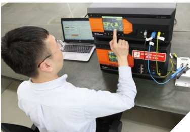
快速瞬变脉冲群抗干扰实验
